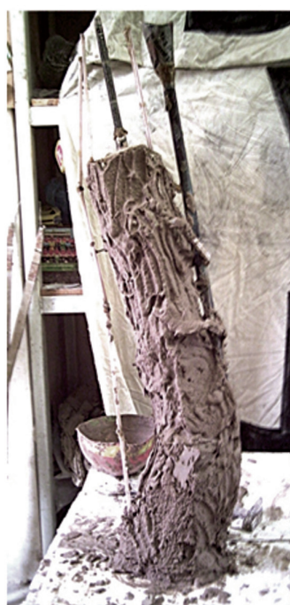
fig.31 Formă alimentată prin metoda indirectă.
