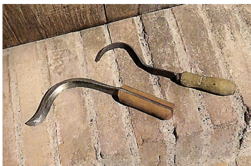
fig.60 Unelte antice pentru finisarea suprafeței bronzurilor, cunoscute sub numele de strigil
