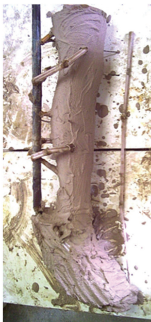
fig.31 Formă alimentată prin metoda indirectă.
