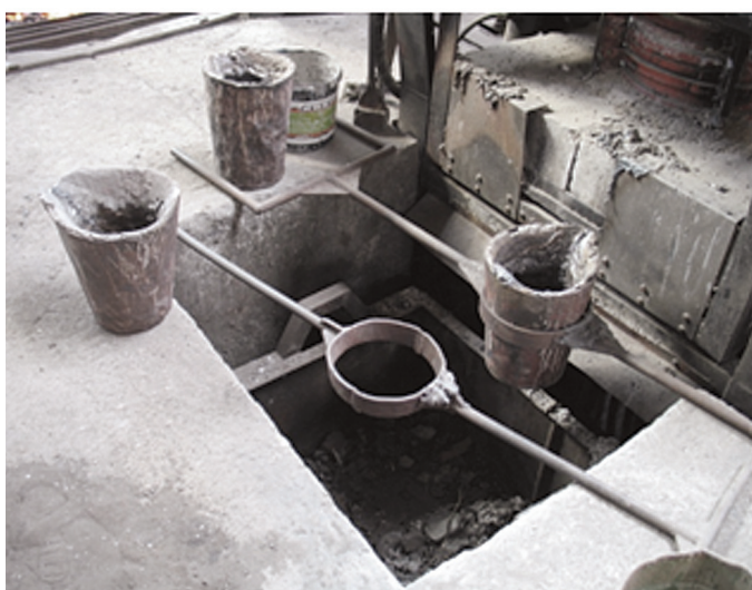
fig.66 Creuzete confecționate artizanal pentru turnarea metalului
