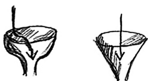
fig.33 Tipuri de pâlnii pentru turnare
